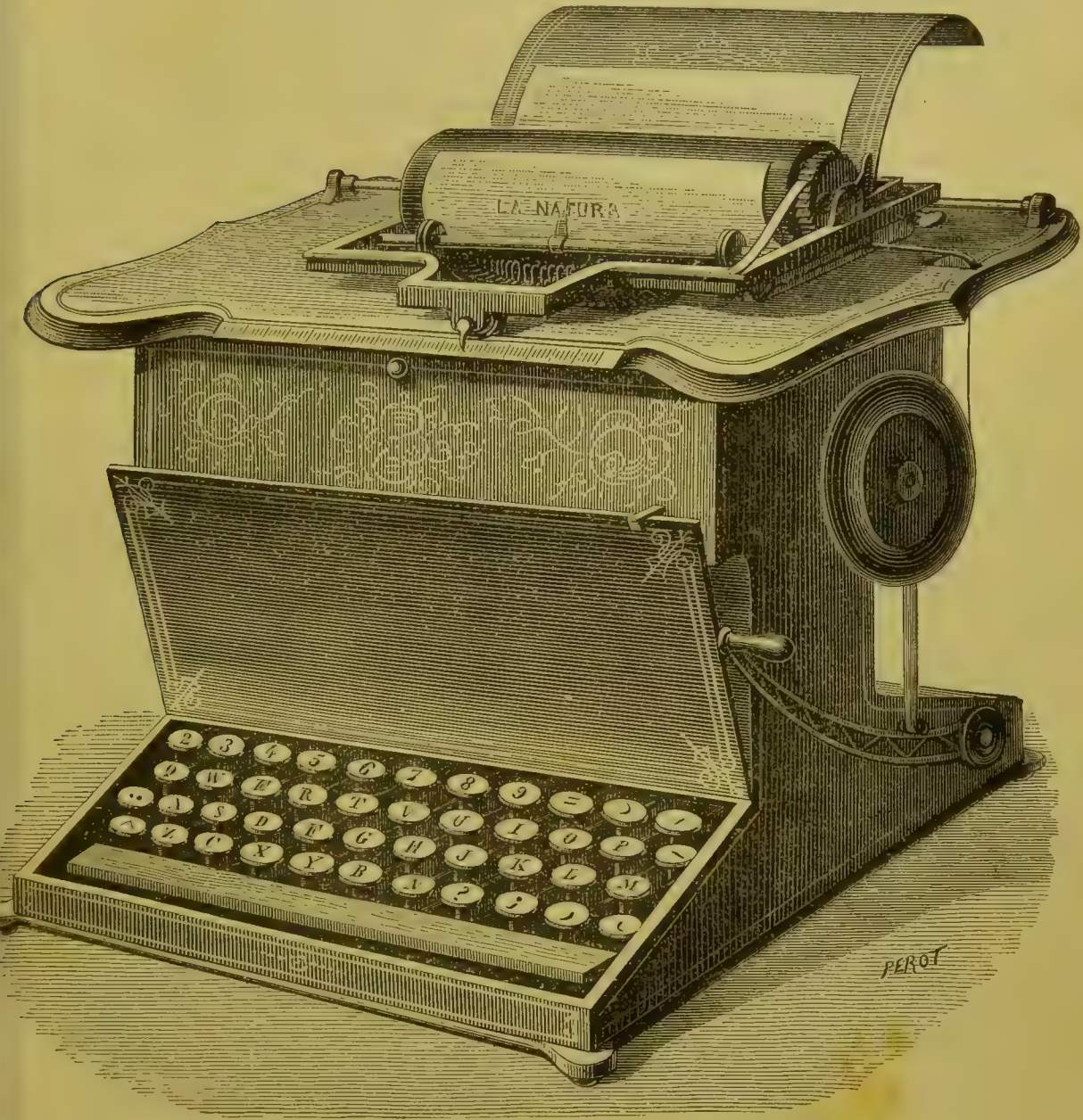
Fig. 239. Macchina da scrivere americana ( \frac{1}{4} della grandezza naturale).
